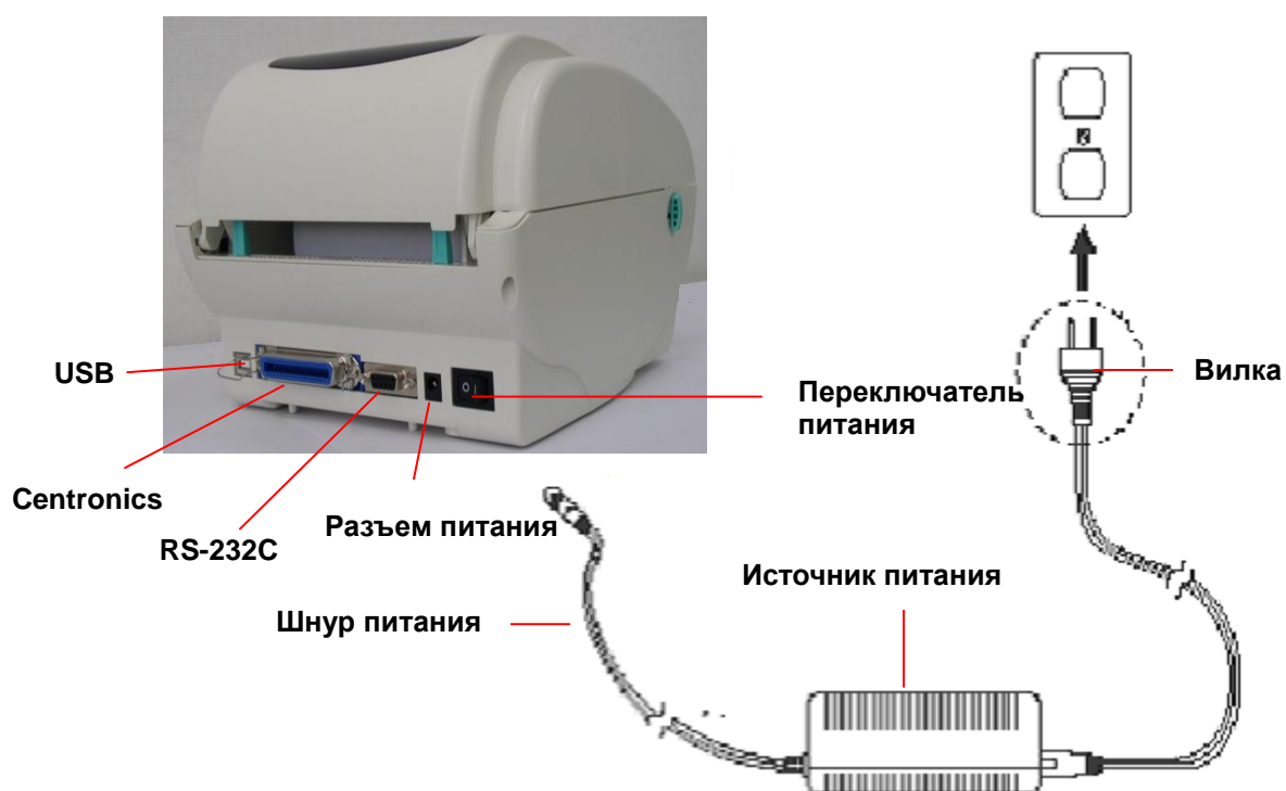
Рис. 5. Подключение источника питания к принтеру
