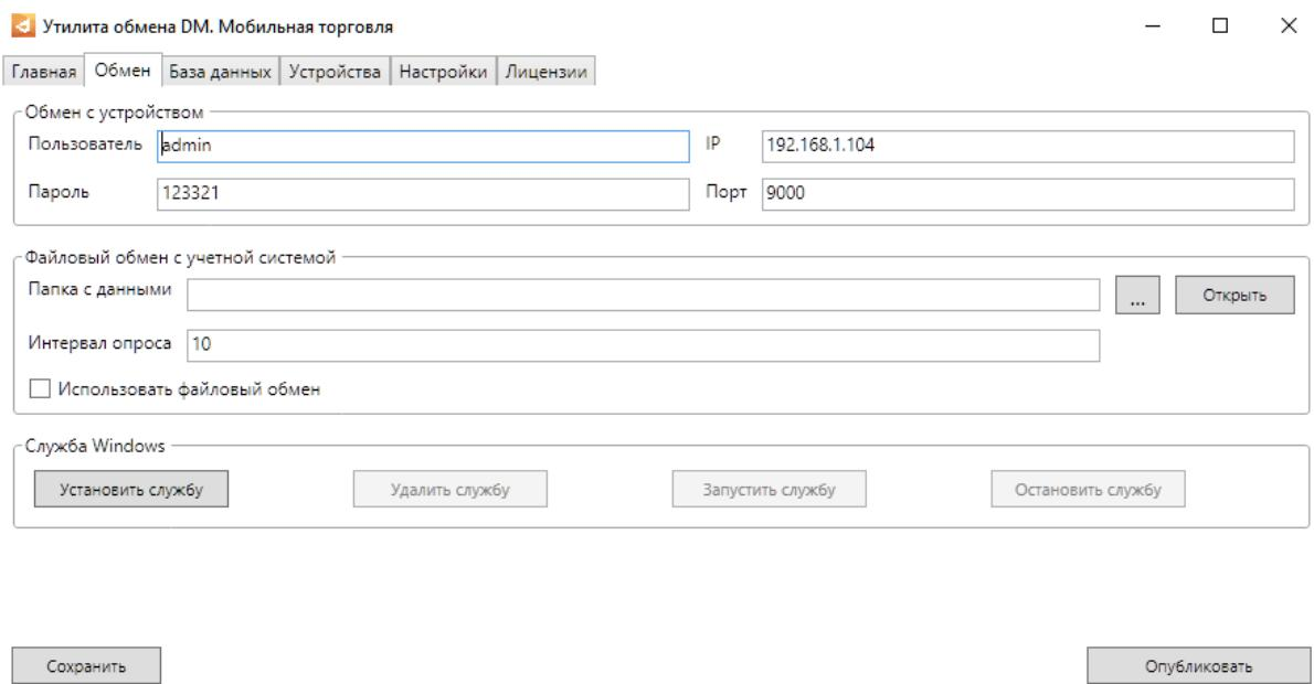
В блоке настроек «Обмен с устройством» указывается порт, ip-адрес компьютера, где установлена серверная утилита **DataMobile Trade** и данные пользователя для подключения к публикации с клиентских устройств.
